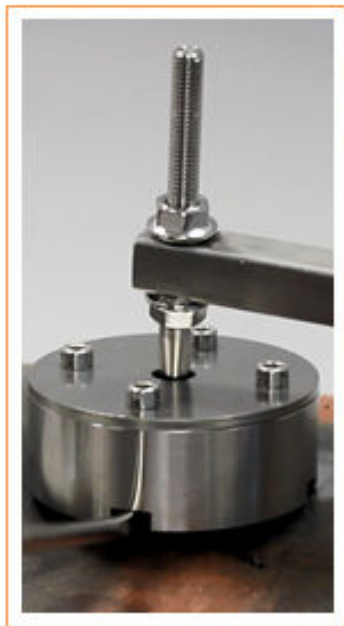
Figura B-3: Elevação da unidade magnética usando uma chave de fenda plana
