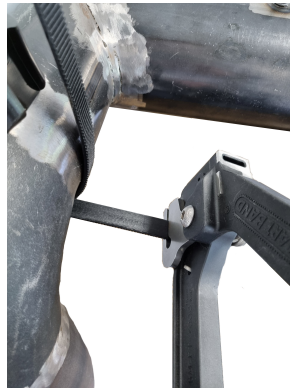
Figura 3-3: Cortando o excesso de correia
