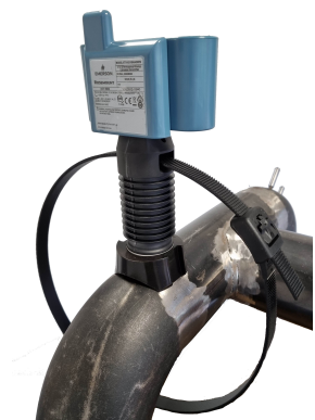
Figura 3-2: Correia solta no sensor
