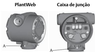
A. Parafuso de ajuste da rotação do invólucro ( $3/32$ -pol.)
