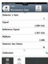
Figura 2-3: Calibração de zero com um comunicador portátil
