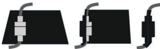
Figura 4-8: Aplicação do Vedante Coaxial em Ligações de Cabo
