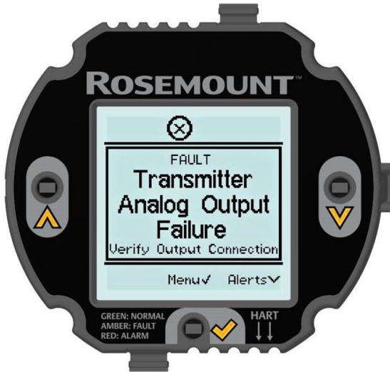
Figura 2-12: Tela Current Loop Fault (Falha de circuito atual)
