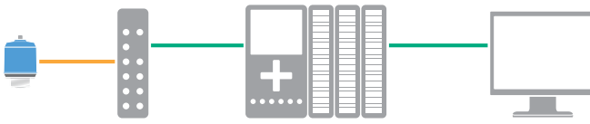
Figura 5-3: Conexión mediante PLC
