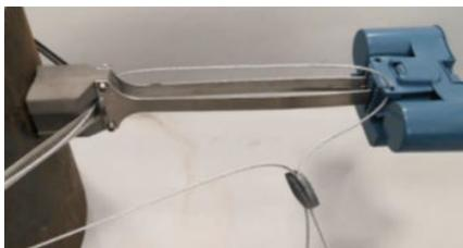
6. Pasar el cable del cordón a través del bloqueador de cable para minimizar la holgura en el cable.
