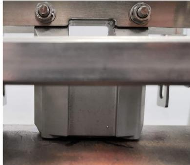
8. Instalar los 4 pernos de fijación del sensor, las arandelas de bloqueo y las tuercas del accesorio magnético como se muestra en [Figura 4-11](#).
