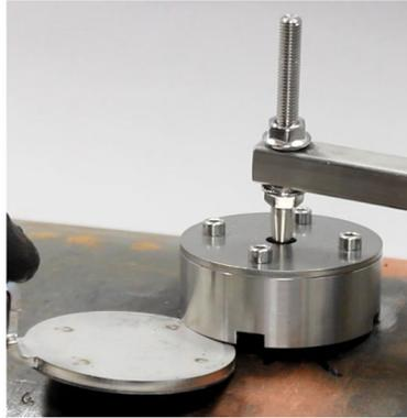
6. Deslizar la unidad magnética hasta la tapa protectora, como se muestra en [Figura 5-6](#).
