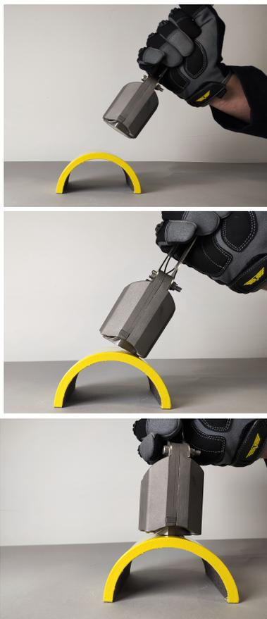
También hay una termocupla en el pie del sensor. Durante la instalación, asegurarse de que la termocupla esté en contacto con la superficie de medición.
