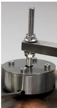
5. Deslizar una tapa protectora debajo de la unidad magnética y retirar el destornillador como se muestra en [Figura 5-5](#).
