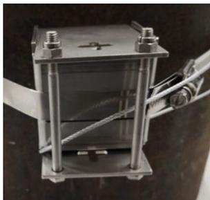
5. Pasar el extremo pelado a través del orificio de la correa de cada sensor, el orificio de la cinta que se encuentra en el cabezal del sensor, hasta el orificio de retorno del bloqueo del cable.
