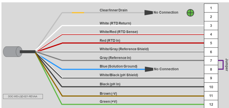
Figura 3-9: Sensor Rosemount pH/ORP 389 con preamplificador para cableado del transmisor Rosemount 5081
