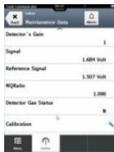
Figura 2-3: Calibración de ajuste del cero con un comunicador portátil
