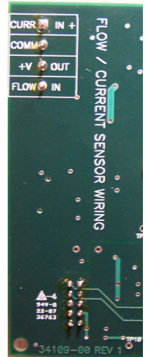
Figura 3-12: Cables conductores de la tarjeta de señal de caudal/corriente de entrada y del sensor
