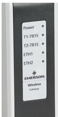
**Figura 4-7: Indicadores del modelo 1410S2 con LED 1 a 5 de izquierda a derecha**
