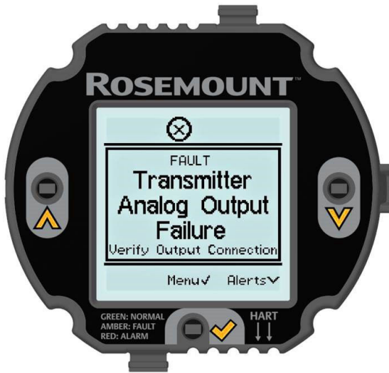
Figura 2-12: Pantalla Current Loop Fault (Fallas del lazo actual)
