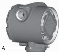
A. Șurub de setare a rotației carcasei ( \frac{3}{32} in.)
