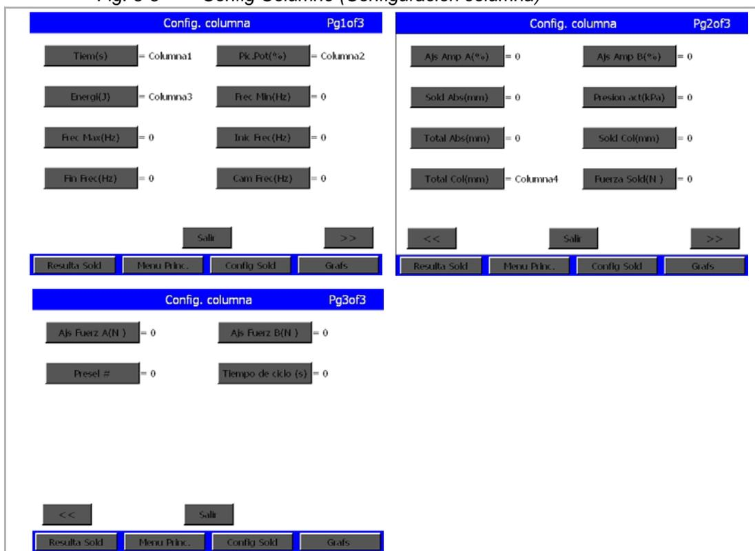
Seleccione el parámetro a visualizar (p.ej. tiempo), pulsando el botón del parámetro deseado. Se abre una ventana de diálogo en la que puede Vd. desconectar el parámetro o escribir una cifra 1 - 4 para la selección de columna pertinente. Los números se corresponden con las columnas en la pantalla "Resulta Solda". Seleccione 'Save' (Guardar) para aplicar el parámetro en su respectiva columna.
