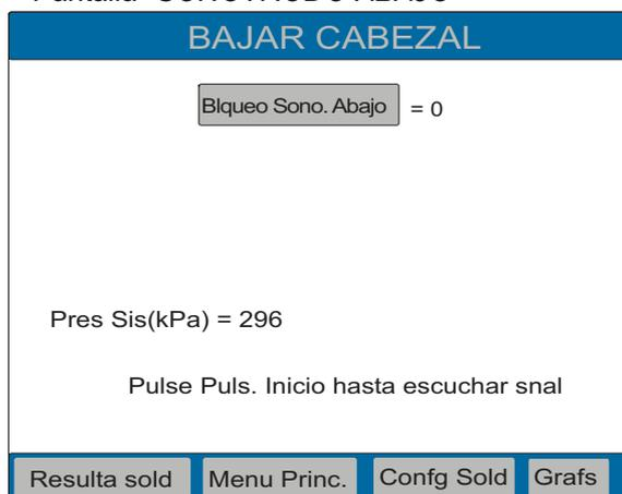
Seleccione para continuar “Bloqueo sono. abajo” 1/0 (ON/OFF) en la parte superior de la pantalla.
