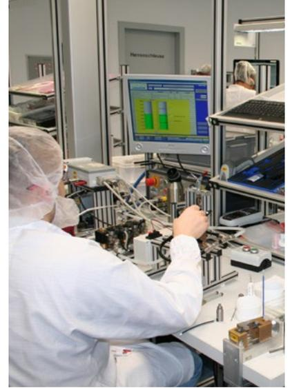
Las soluciones de diseño se fabrican en un entorno de sala blanca equivalente a la clase 8 para minimizar la contaminación, lo que evita tener que repetir el proceso de fabricación.
