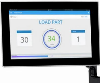
HMI intuitiva con pantalla táctil ubicada directamente en la línea de visión del operador. Permite a los operadores tener siempre un acceso directo a los datos críticos de soldadura aplicables.
