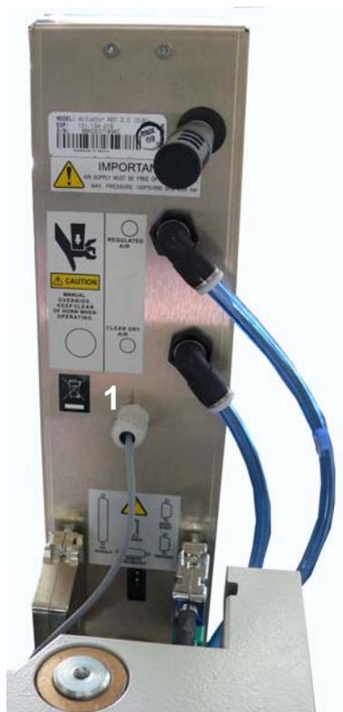
1 = Anschluss für das Magnetventil
