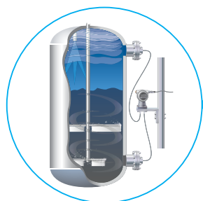
Système avec deux capillaires de longueur identique
