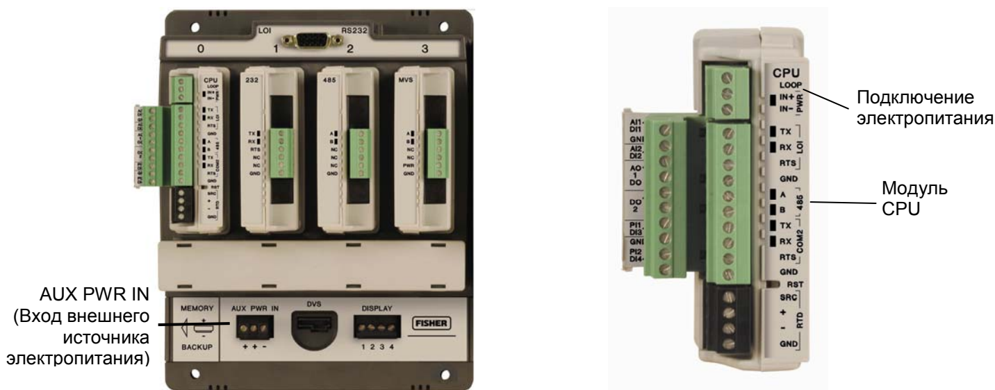
Рис. 3-1. Разъемы для подключения электропитания контроллера FB107
