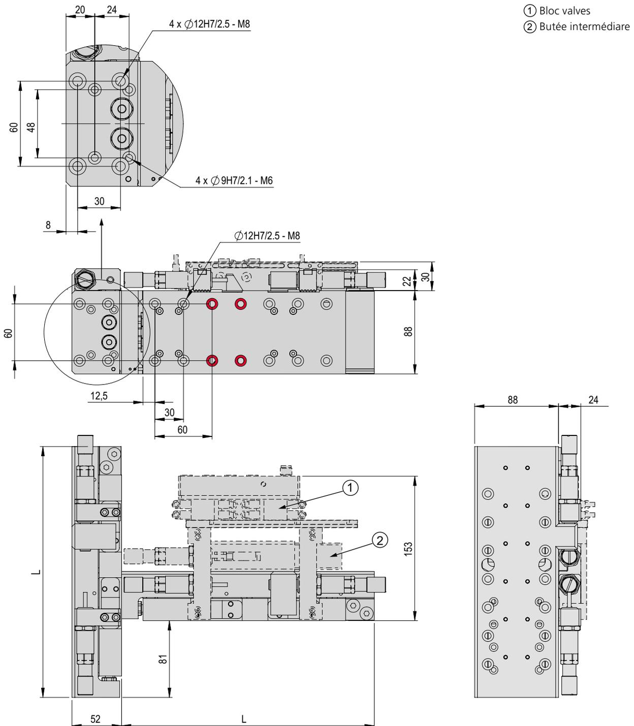
⊕ Perçages à vissage traversant. Autres perçages vissables et perçages vissables disposés autrement, voir catalogue composants HT, linéaires.
