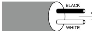
Construits en fer et Constantan, les thermocouples de type J se caractérisent par une plage de température potentielle de  $-40$  à  $1\,400$  °F ( $-40$  à  $760$  °C) et une sensibilité d'environ  $50 \mu\text{V}/^\circ\text{C}$ . Les thermocouples de type J deviennent fragiles en dessous de  $32$  °F ( $0$  °C) et conviennent à une utilisation dans le vide, en atmosphère réductrice ou atmosphère inerte. L'utilisation de ces thermocouples dans une atmosphère oxydante réduit leur durée de vie.
