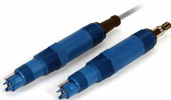
Les sondes de pH/ORP Rosemount 3900 et 3900VP pour applications générales comportent un corps en plastique Ryton® résistant aux agents chimiques, avec une mise à la terre intégrée pour un diagnostic avancé et une sonde de température (RTD) Pt-100 pour la compensation de température. Ces sondes sont disponibles avec un raccordement par câble intégré (Rosemount 3900) ou avec un connecteur Variopol (VP8) (Rosemount 3900VP). Les câbles Variopol sont vendus séparément (voir [Accessoires](#)).
