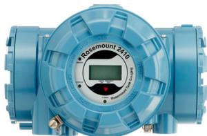
Le concentrateur Rosemount 2410 gère la communication de données entre les appareils de terrain et la salle de commande. Il existe en deux versions, pour un seul ou plusieurs bacs. Les options de communications en salle de commande comprennent les suivantes : Modbus<sup>®</sup>, CEI 62591 (protocole WirelessHART<sup>®</sup>) et l'émulation de protocoles d'autres fournisseurs.
