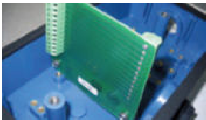
Illustration 20 : La boîte de jonction réf. 23550-00 est dotée d'une carte d'extension, mais pas de préamplificateur
