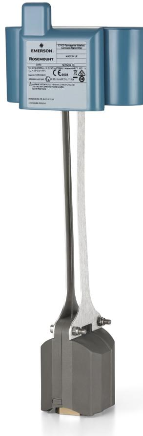
Os sensores wireless Permasense da Rosemount fornecem medição direta da espessura da parede, a indicação mais precisa da integridade do ativo. O transmissor utiliza processamento de sinal patenteado para lidar com a rugosidade da superfície interna causada por alguns mecanismos de corrosão e o melhor material da classe e compensação de temperatura. Esses recursos se combinam para oferecer repetibilidade de medição e sensibilidade líderes do setor em condições de campo.
