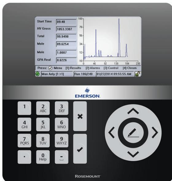
Você pode executar a maioria das funções de manutenção de rotina do GC diretamente a partir da LOI. Na maioria dos casos, os operadores podem instalar, configurar e colocar o GC on-line sem usar um computador.
