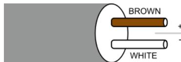
Construídos de cobre e constantan, os termopares do Tipo T têm uma faixa de temperatura potencial de -321 a 698 °F (-196 a 370 °C) e uma sensibilidade de 38 µV/°C. Os termopares do Tipo T demonstram uma boa linearidade e podem ser usados em atmosferas oxidantes, redutoras ou inertes, bem como em vácuo. Estes termopares exibem uma elevada resistência à corrosão por unidade e são tipicamente utilizados em faixas de temperaturas muito baixas (criogênicas) a médias.
