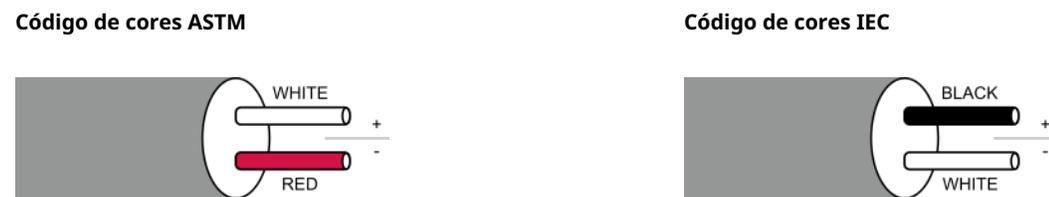
Construídos em ferro e constantan, os termopares Tipo J têm uma faixa de temperatura potencial de -40 a 1.400 °F (-40 a 760 °C), e uma sensibilidade de cerca de 50 µV/°C. Os termopares do Tipo J tornam-se quebradiços abaixo de 32 °F (0 °C) e são adequados para uso em atmosferas de vácuo, redutoras ou inertes. Estes termopares terão uma vida reduzida se usados em uma atmosfera oxidante.
