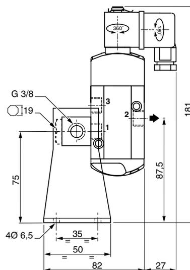
Dieses Teil ermöglicht die Montage der Schieberventile in 4 verschiedenen Positionen.
