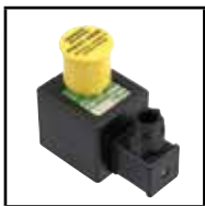
TYP 05: Magnet mit Epoxidharz vergossen SC: IEC 335 / ISO 4400 ISSC: EN/IEC 60079-11+26, 61241-11
