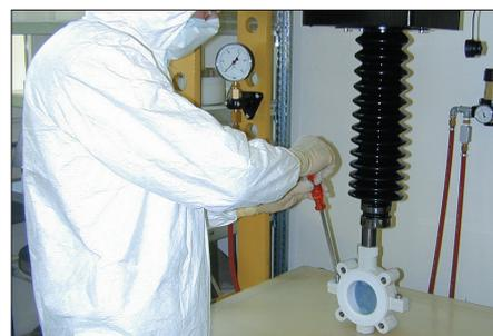
Montagem da válvula em sala de ambiente controlado
