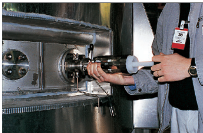
Robinet de prise d'échantillon pour cuve. Un échantillon est prélevé avec une seringue de 250 ml
