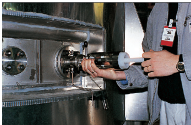
Válvula de amostragem de tanque Recolha de uma amostra com uma seringa de 250 mL
