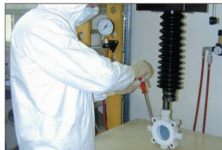
Montaje de la válvula en la sala limpia
