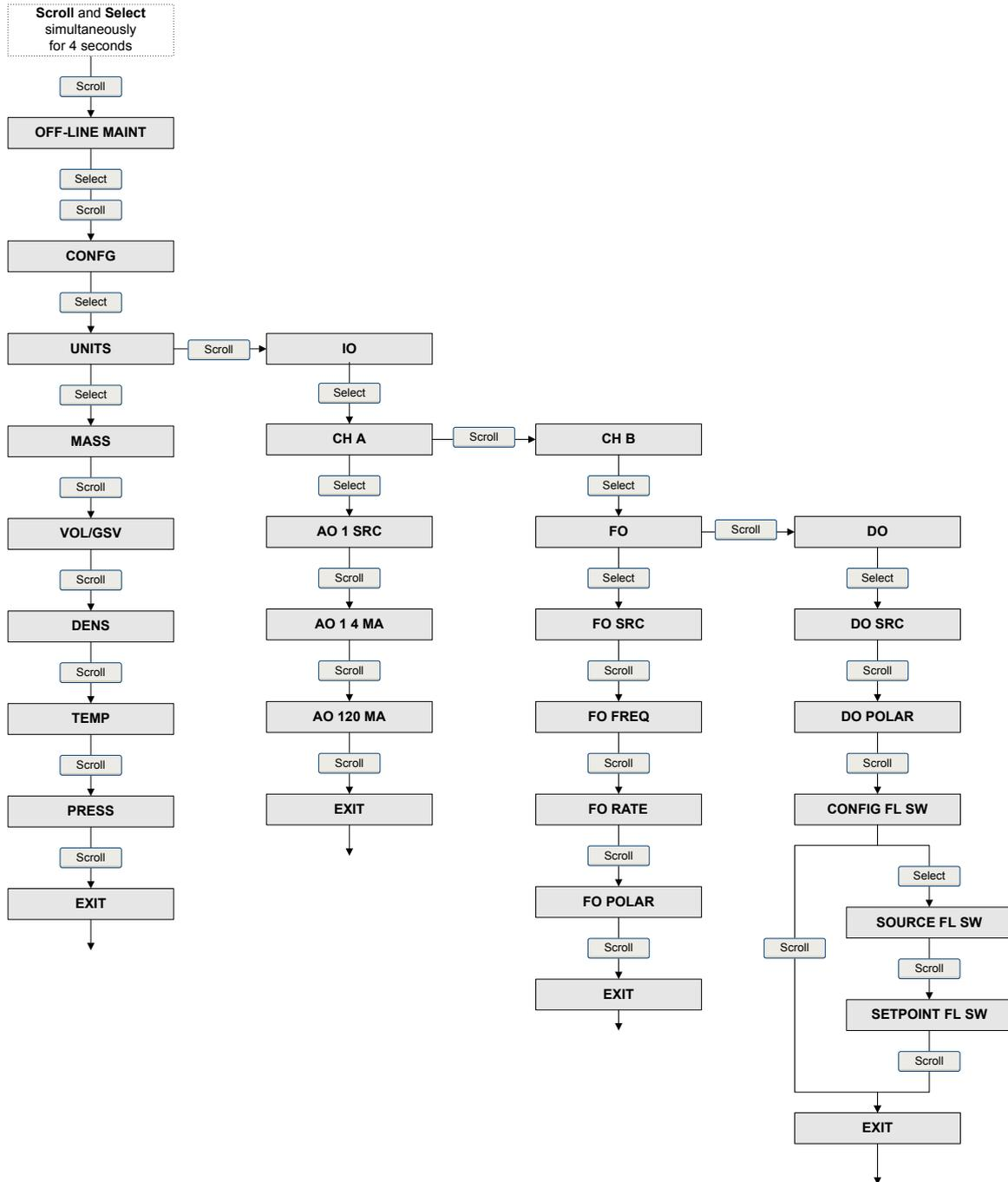
**Figura A-5: Menú fuera de línea: configuración del factor del medidor, el indicador y las comunicaciones digitales**
