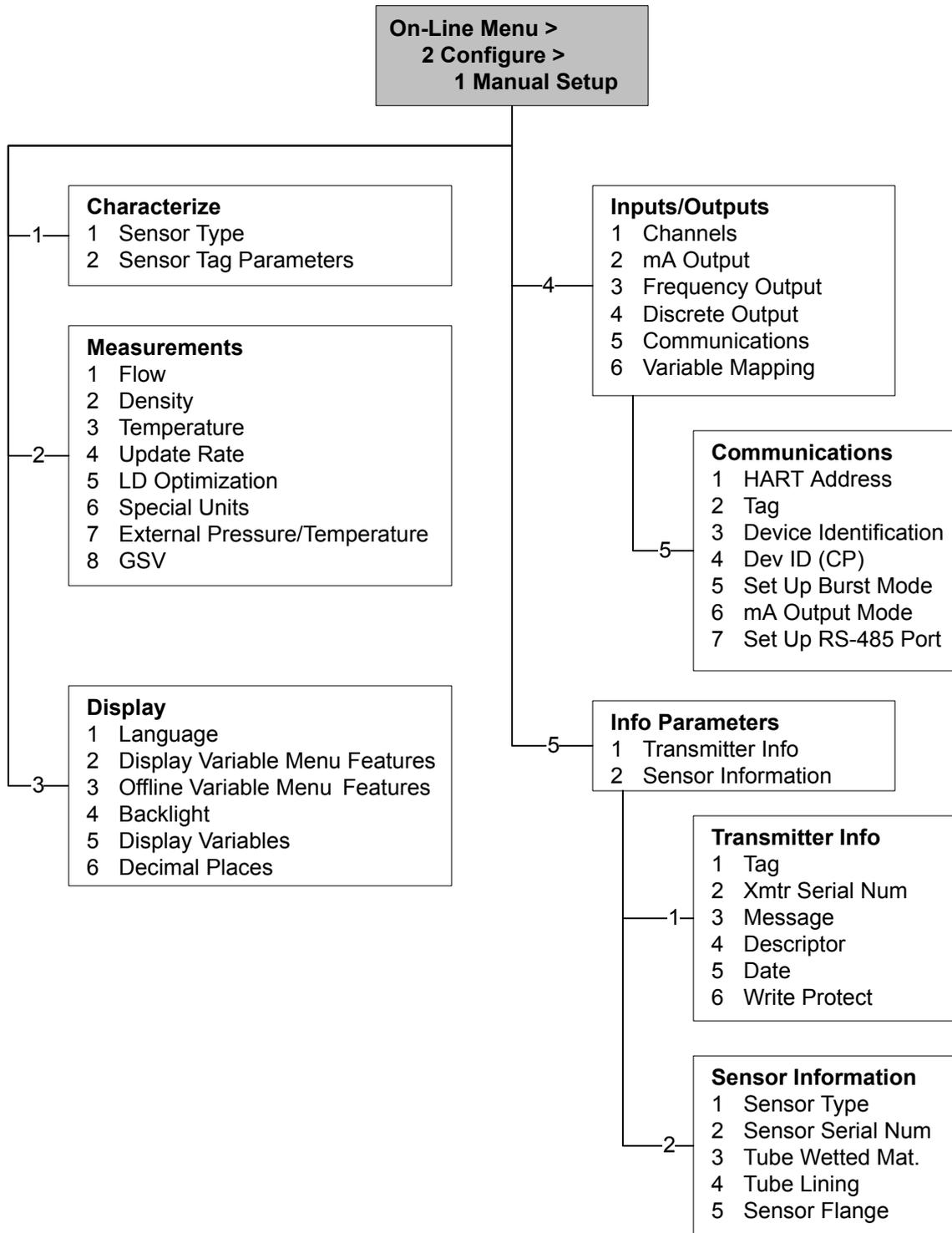
Figura D-8: Menú Configuración manual: Caracterizar
