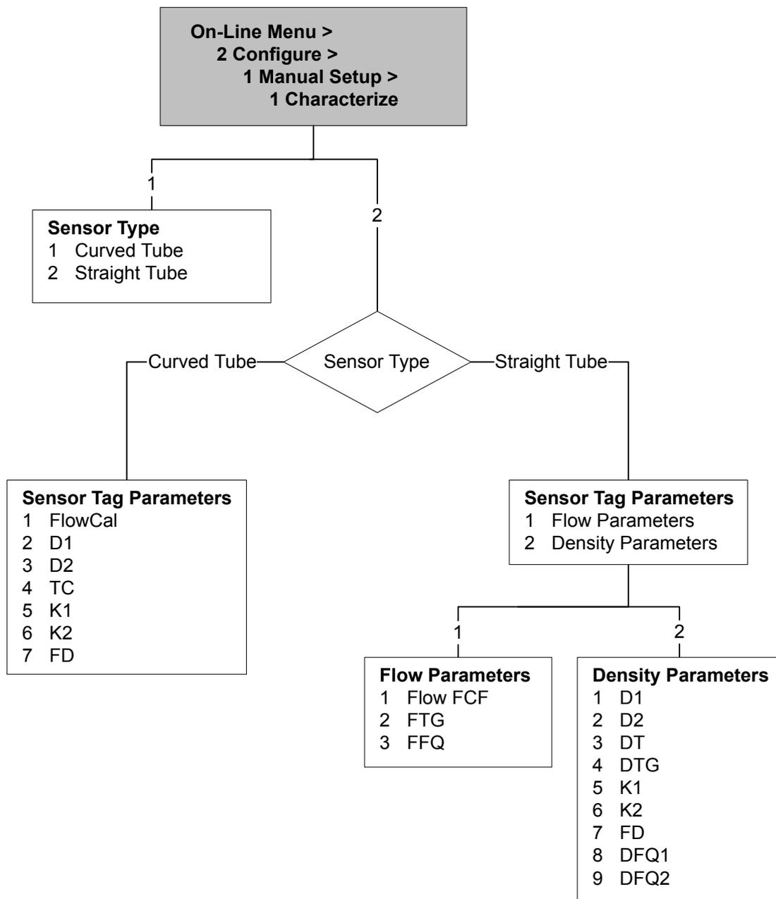
Figura D-9: Menú Configuración manual: Mediciones
