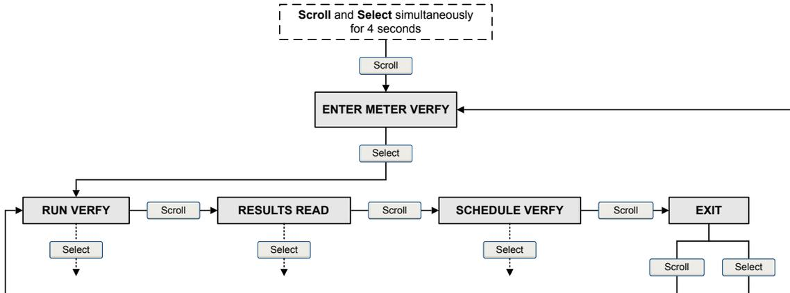
**Figura A-8: Menú fuera de línea: programa de verificación del medidor**
