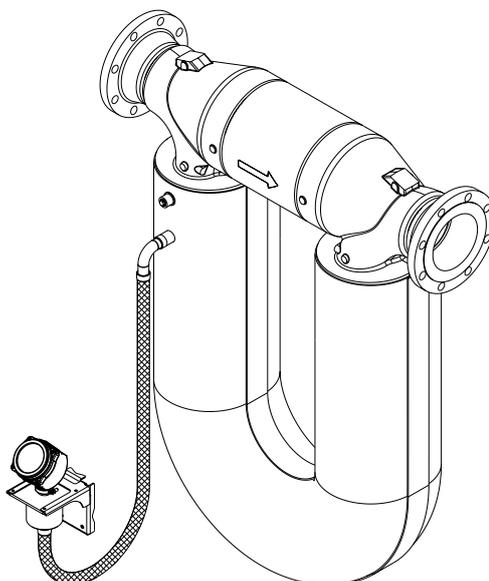
Las instalaciones de conducto flexible para alta temperatura se realizan con las mismas instrucciones que las instalaciones remotas de 4 hilos, pero la distancia entre el sensor y la electrónica está limitada por la longitud del conducto flexible.
