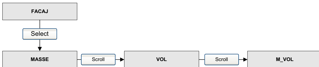
Figure B-12 Arborescences de l'indicateur – Menu de maintenance : Configuration : Facteurs d'ajustage de l'étalonnage
