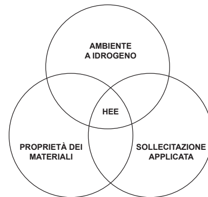
Figura 1. Schema dell'infragilimento nell'ambiente a idrogeno
