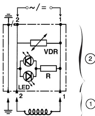
**LED** - diode électroluminescente verte, bidirectionnelle pour signalisation de présence de tension aux bornes de la bobine (24V CA/CC, 115V CA, 230 V CA)
