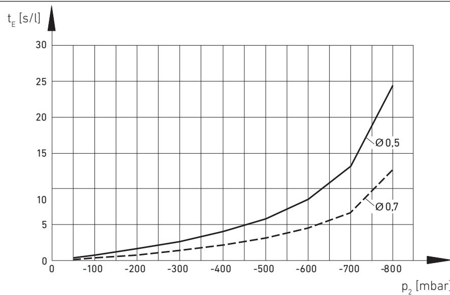
Evakuierungszeit  $t_E$  in Abhängigkeit vom Vakuum  $p_2$  für 1 l Volumen (bei optimalem Betriebsdruck  $p_{1 \text{ opt.}}$ ) /
