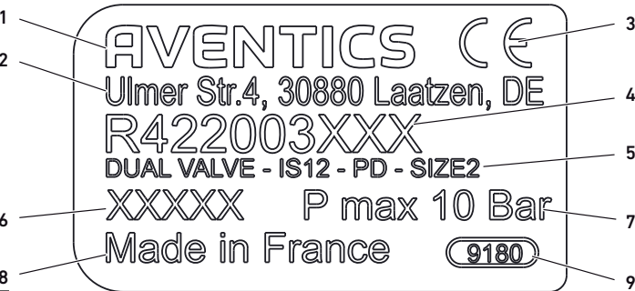
Typenschild | Plaque signalétique | Name plate | Targhetta dati | Placa de características | Typskylt 1: Firmenname | nom de la société | Company name | nome azienda | Nombre de la empresa | Tillverkarnamn 2: Firmenadresse | adresse de la société | Company address | indirizzo azienda | Dirección de la empresa | Tillverkarens adress 3: CE-Kennzeichnung | marquage CE | CE mark | marchio CE | Marcado CE | CE-märkning 4: Materialnummer | référence | Material number | codice | Número de material | Materialnummer 5: Typenbezeichnung | Désignation | Type designation | denominazione del tipo | Denominación de tipo | Typbeteckning 6: Fertigungsdatum | date de fabrication | Production date | data di produzione | Fecha de fabricación | Tillverkningsdatum 7: Maximaldruck | pression maximale | Maximum pressure | pressione massima | Presión máxima | Maximalt tryck 8: Herstellungsland | pays de fabrication | Country of manufacture | paese di produzione | País de fabricación | Tillverkningsland 9: Verantwortliches Werk | usine responsable | Responsible plant | stabilimento responsabile | Fábrica responsable | Ansvarig fabrik
