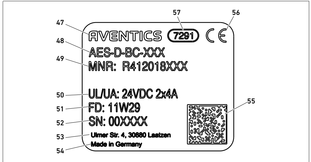
Fig. 16: Targhetta dati dell'accoppiatore bus
