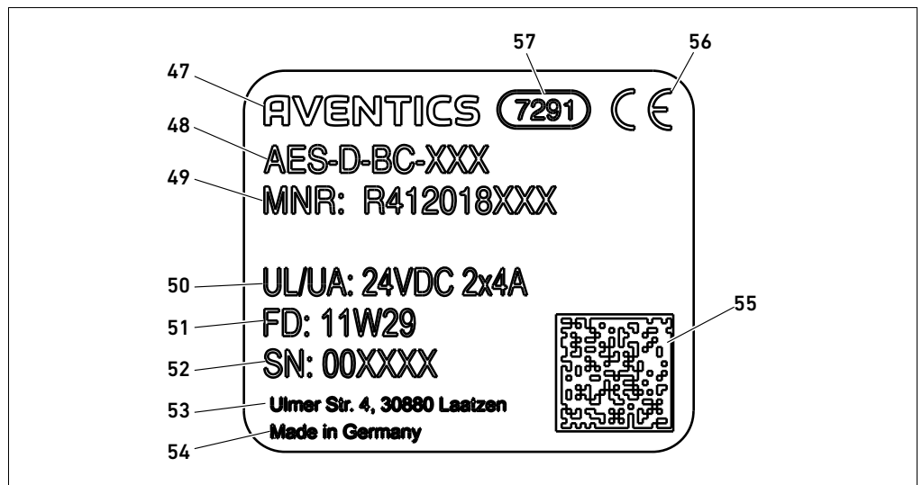
Fig. 16: Plaque signalétique du coupleur de bus
