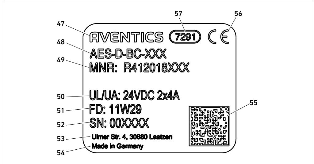
Abb. 16: Typenschild des Buskopplers
