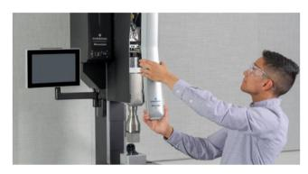
Ein fortschrittliches elektromechanisches Vorschubsystem, das mit der Serie GSX-Elite Precision verfügbar ist, kann sich dank Echtzeit-Rückkopplung unmittelbar anpassen. Dies verbessert die Genauigkeit bei einer Vielzahl von Anwendungen und Bauteilen (geschlossener Regelkreis).
