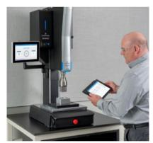
Die einstellbare Regelung der Absenkgeschwindigkeit mit Energieund Kraftprofilen während eines Schweißvorgangs ist einer der Hauptvorteile der modernen elektromechanischen Vorschubtechnik
