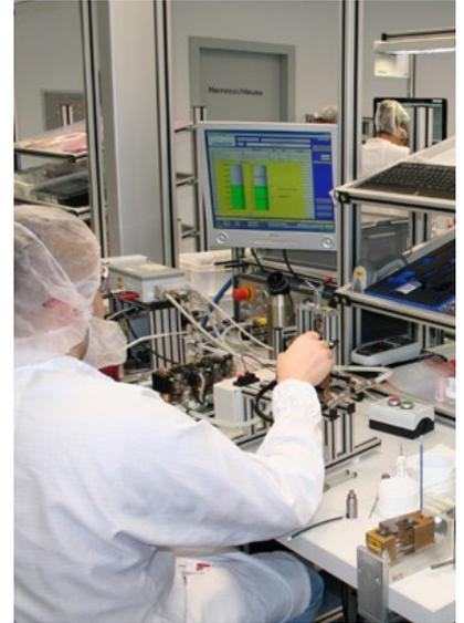
Die maßgeschneiderten Lösungen werden in einer der Class 8 entsprechenden Reinraumumgebung gefertigt, um Verunreinigungen zu minimieren und somit Nacharbeiten zu verhindern.
