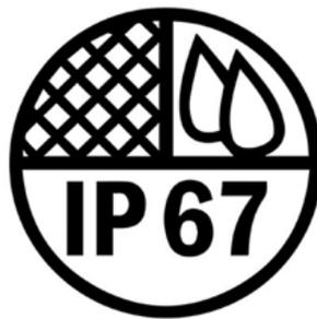
Schutzart IP67 (staubdicht und bis zu 1 Meter in Wasser eintauchbar) ermöglicht die Installation in rauerer Umgebungen.
