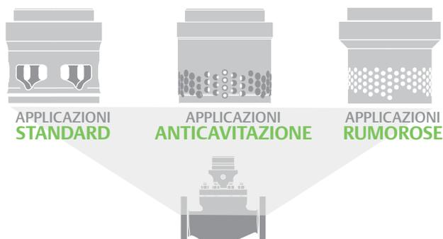
Il singolo design del corpo valvola si adatta a un'ampia gamma di applicazioni, in modo che la formazione dei tecnici e del personale di manutenzione possa essere dedicata a come applicare rapidamente le valvole easy-e ai diversi processi dell'impianto.
