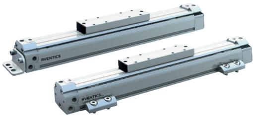
**Fixations universelles** – Il est possible d'utiliser les mêmes fixations pour toutes les variantes. Fixations de couvercle pour le couvercle terminal. Des fixations par patte d'équerre, montées sur le côté dans les rainures, stabilisent le profilé pour les courses plus longues.
