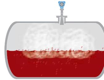
Misurazione accurata e affidabile del livello in serbatoi con schiuma, turbolenza, condensa e media a bassa DC.
