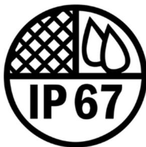
L'indice de protection IP67 (étanche à la poussière et submersible jusqu'à 1 mètre d'eau) permet une installation dans des environnements plus difficiles.
