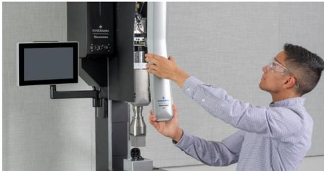
Le système avancé d'actionnement électromécanique, disponible avec la série Branson GSX-Elite, s'ajuste instantanément en fonction du feedback en temps réel. Cela améliore la précision sur une large gamme d'applications et de composants (boucle fermée).
