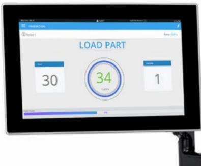
L'IHM intuitive avec écran tactile, située directement dans la ligne de visée de l'opérateur, lui permet d'avoir accès en permanence aux données de soudage importantes, exploitables.
