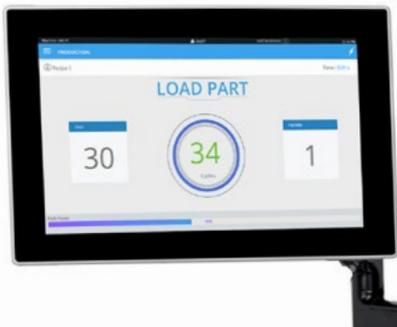
L'intuitiva HMI con display touchscreen situata direttamente nel campo visivo dell'operatore consente costantemente l'accesso a dati di saldatura fondamentali.
