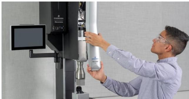
L'avanzato sistema di attuazione elettromeccanico, disponibile con la serie Branson GSX-Elite Precision, esegue regolazioni istantanee sulla base di un feedback in tempo reale. Questo migliora la precisione in una vasta gamma di applicazioni e componenti (a circuito chiuso).
